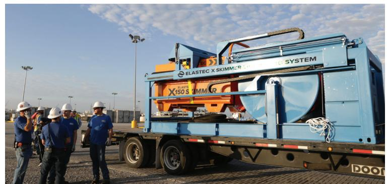
エラストックXスキマー投入システムは、3名で簡単に操作できます。このシステムを使用すれば、X150を作業船から海上に設置する際の重作業を、すべて油圧の遠隔操作により船尾から引き上げ、海上に下ろすことができます。
