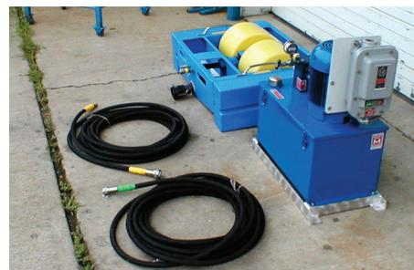
電動式油圧動力装置、スキマーヘッド、油圧ホース
