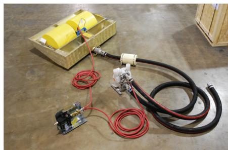
空気圧駆動の油回収機、ダイヤフラムポンプ、エア供給ホース、吸い上げ/排出ホース
