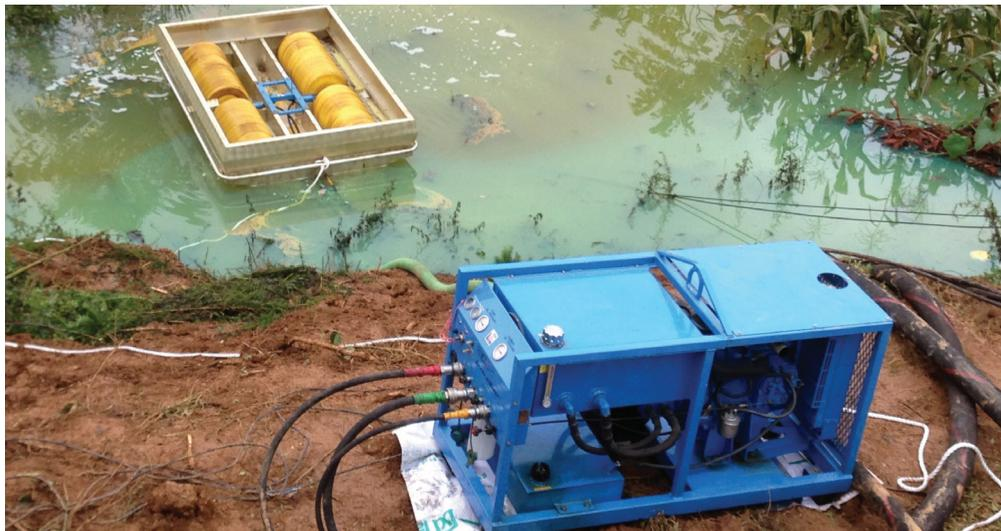
エラストックは、オイルフェンス用のリールや油回収機、ポンプを駆動する多様な油圧パワーパックを揃えています。パワーパックは、ディーゼル駆動と電動があります。電動モデルは、製油所やその他爆発の危険性のある場所では、防爆構造でも提供可能です。遠隔地への移送の場合、ATVタイヤやトラックが利用可能です。
