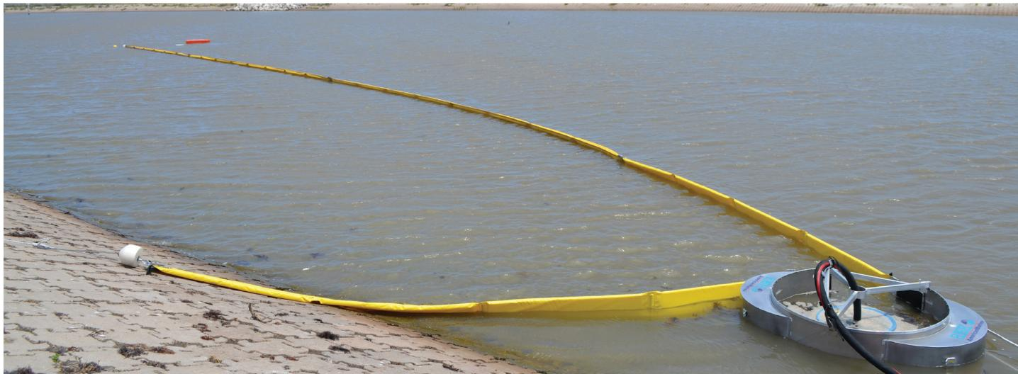
エラストックのサーカス・リバースキマーは、河川用オイルフェンスと曳航装置を組み合わせた直列形の油回収機で、油と水を分離します。この油回収機は、油を回収し集積する環状の構造と、その底部から水を排出するように設計されています。流れの早い河川での使用に最適です。オムセットでの試験では、流速2ノットで流れる油の90%を回収しました。
