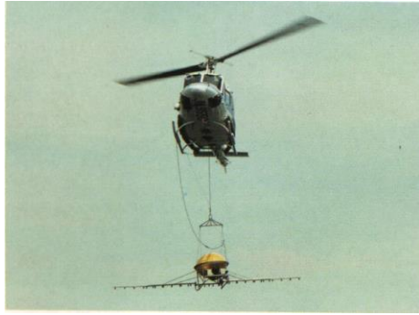
除油劑於空中散布裝置
